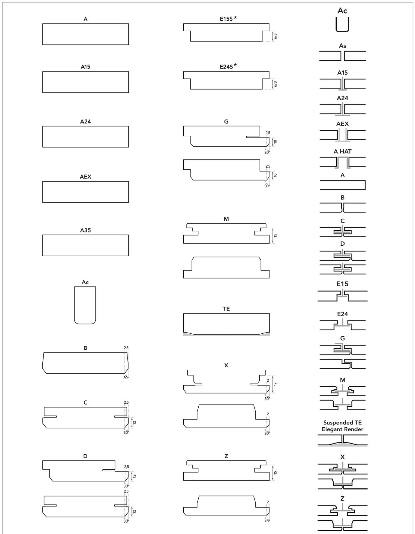
\* Longitud de reposo del panel sobre la perfilera: 5 mm. La oferta puede variar según la planta de producción, con diferentes profundidades del escalonado: E15S8: 3,75 mm (CIG) y 4 mm (SELM). E24S8: 5 mm (CIG) y 4 mm (SELM). Por favor, contáctenos para más información.
