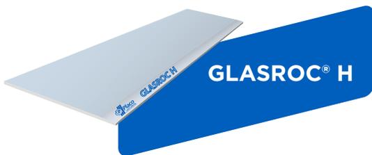
Placa de yeso para exterior revestida con matt de fibra de vidrio, altamente hidrofugada, apta para zonas interiores expuestas a humedad muy fuerte, techos exteriores y otras zonas que no formen parte de la fachada Placotherm®.
