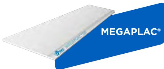
Placa de Yeso Laminado con los bordes longitudinales afinados, de 900 mm de anchura, que proporciona una gran robustez, rápida instalación y ahorro de material gracias a su espesor de 25 mm.
